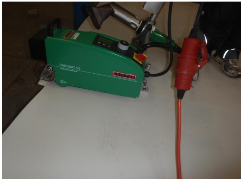
Foto 5 Die Naht wird mit Heißluft geschlossen.
