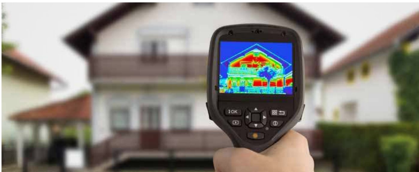
Eine Wärmebildkamera macht Infrarotstrahlung sichtbar und eignet sich daher hervorragend, um Leckagen in der Gebäudehülle zu erkennen.
