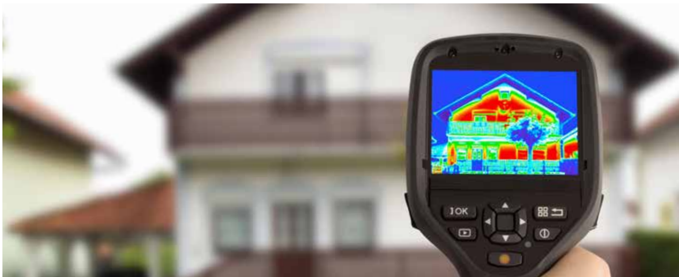
Die roten Stellen dieser Thermografie machen sichtbar, wo am Haus die Schwierigkeiten liegen und am meisten Wärme verloren geht.
